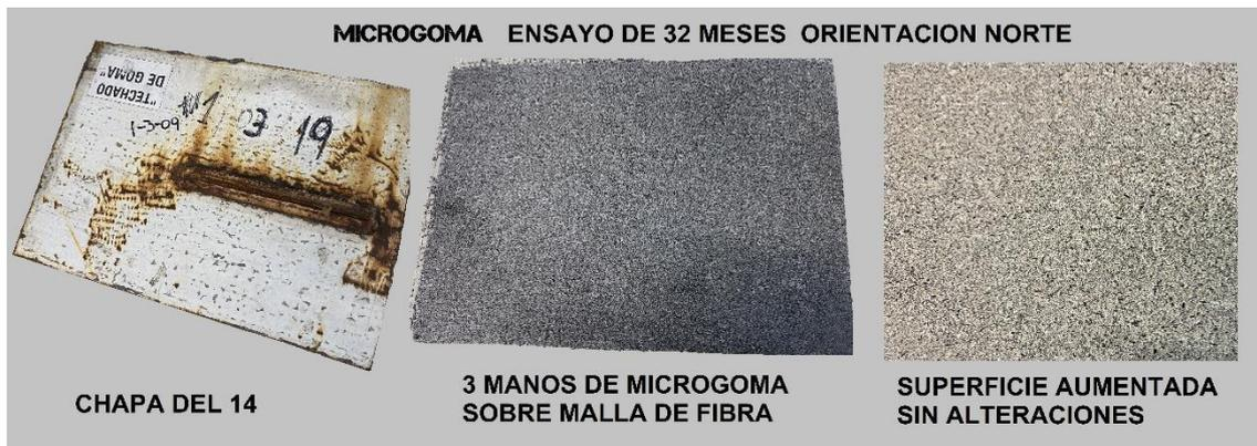
RESULTADO: Al retirar la chapa, la misma tenía una temperatura de 82°C pero del lado del revestimiento, estaba a temperatura ambiente. El aspecto visual es idéntico al día en que se aplicó y observado con un potente lente de aumento cuenta hebras no se observaron alteraciones de ningún tipo. No hay micro fisuras ni contracciones. Por otra parte, al rasparlo con la uña, la flexibilidad de las partículas de goma están intactas.
